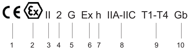
Abb. 14 Explosionsschutz-Kennzeichnung an der Pumpe (Gerätegruppe II, Kategorie 2)
