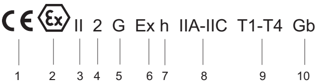
Fig. 14 Marquage relatif à la protection antidéflagrante de la pompe (groupe d'appareils II, catégorie 2)
