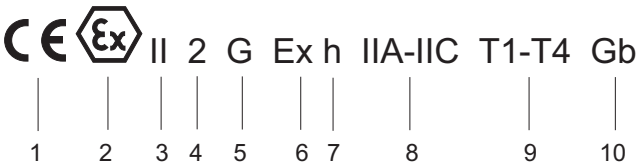
Fig. 14 Identificador de protección antiexplosión en la bomba (grupo de aparatos II, categoría 2)
