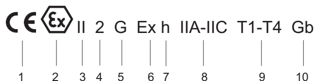
Afb. 14 Markering voor explosiebeveiliging aan de pomp (apparaatgroep II, categorie 2)
